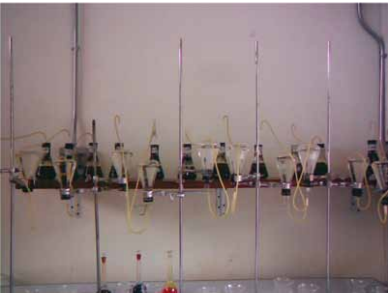
Figura 1. Montaje de reactores bath para la degradación anaerobia del colorante Rojo Punzó.
