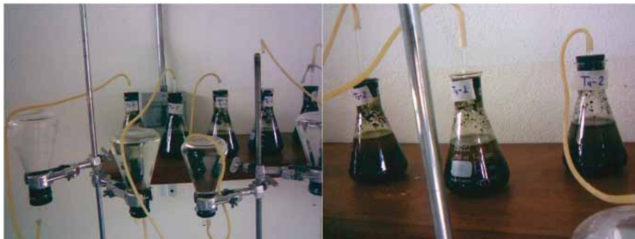
Figura 2. Reactores Bath para la degradación anaerobia del colorante Rojo Punzó.
